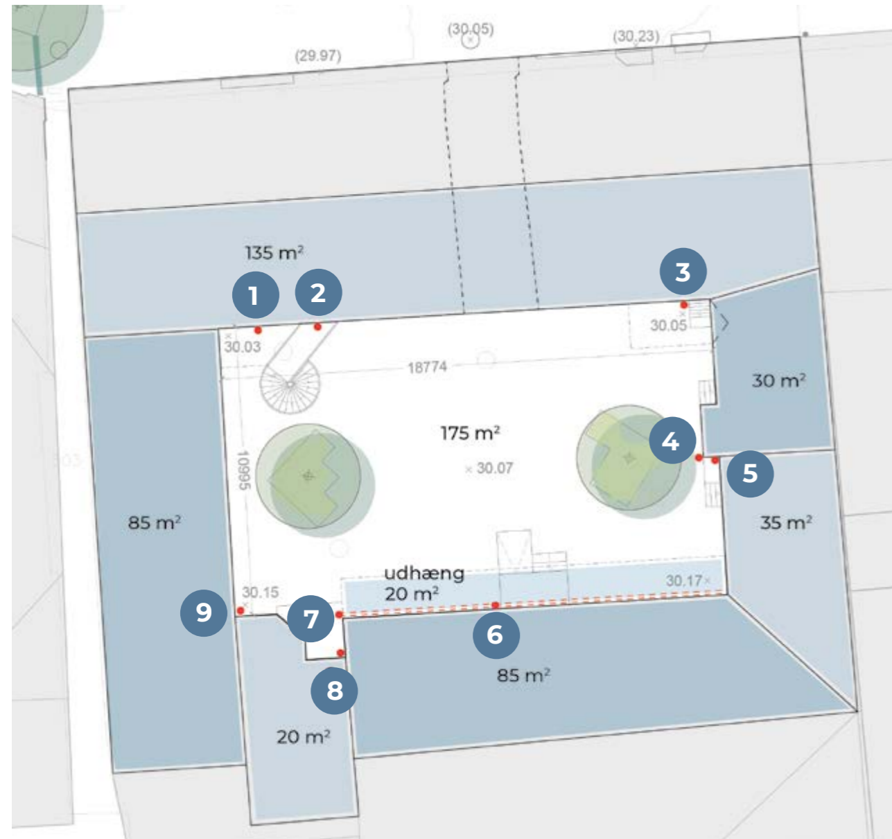
Tagnedløb 6 og 7 løber sammen ved tagnedløb 7 og afvander ca. 85 m 2 samt udhænget over Rodes.
