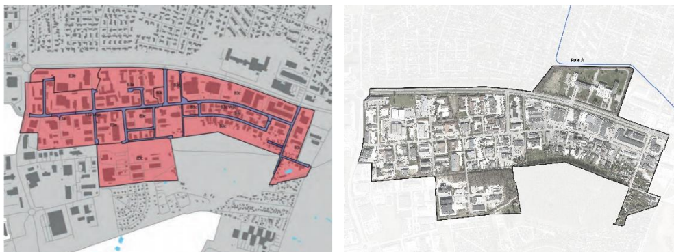
Figur 1 (tv): Indsatsområde for separering af fællessystemet i Rønnevang Erhvervsområde. Figuren viser kloakoplande, som i Spildevandsplan 2018-2021, er udpeget til fraseparering af regnvand fra veje, pladser og kommunale ejendomme indenfor den nuværende planperiode. Status/plan - Fællessystem er markeret med rødt mens plan - Separering er markeret med blå. Figur 2 (th): Afgrænsning af projektområdet.
