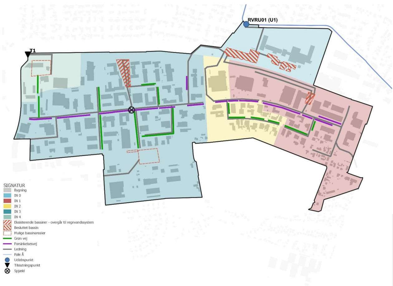
Figur 8: Best case for løsningsstruktur for det nye regnvandsystem til hverdagsregn i Rønnevang Erhvervsområde (Modningen, juni 2020). Stor udgave af kortet kan ses i bilag A.
